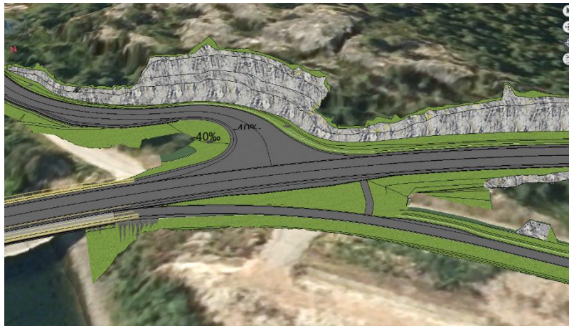
Figur 20: Nærbilde av kryss mot kommunal veg Seterdalen og sti ned til gang-/sykkelveg på nordsiden av E6
