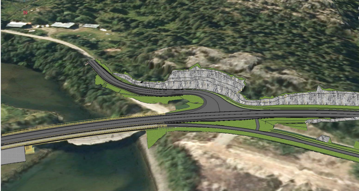
Illustrasjon som viser ny bru, bergskjæring samt ny avkjørsel mot kommunal veg Seterdalen.
