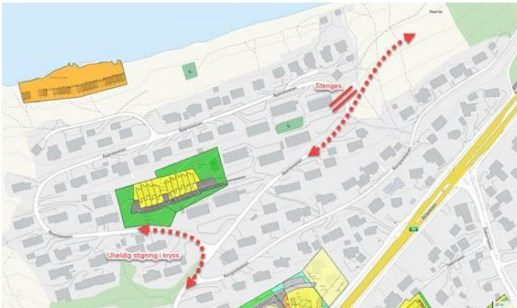
Figur 30 – Vurdert alternativ 1 for vegsystemet i området; Ikke rundkjøringsmulighet.
