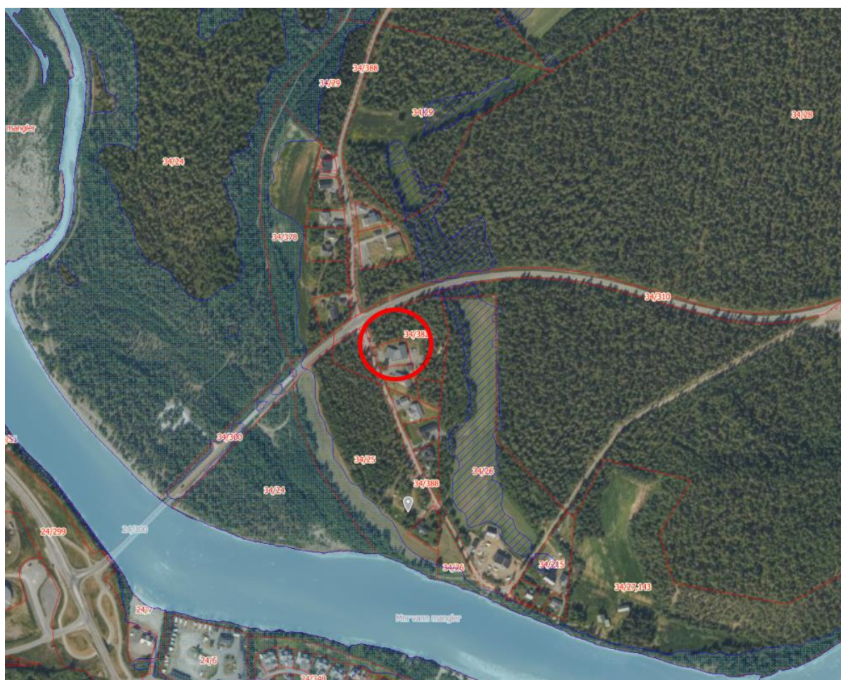
Figur 7-2: Aktsomhetskart for flom. Aktsomhetsområder i skravert blå farge. Planområdet med tilhørende tiltak markert med rød sirkel. Kilde Scalgo.com
