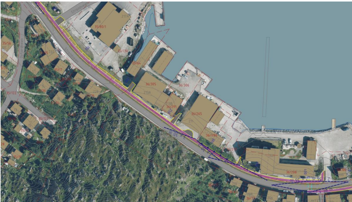
Figur 25: Fortau på nordsiden av vegen frem til Strandveien 201.
