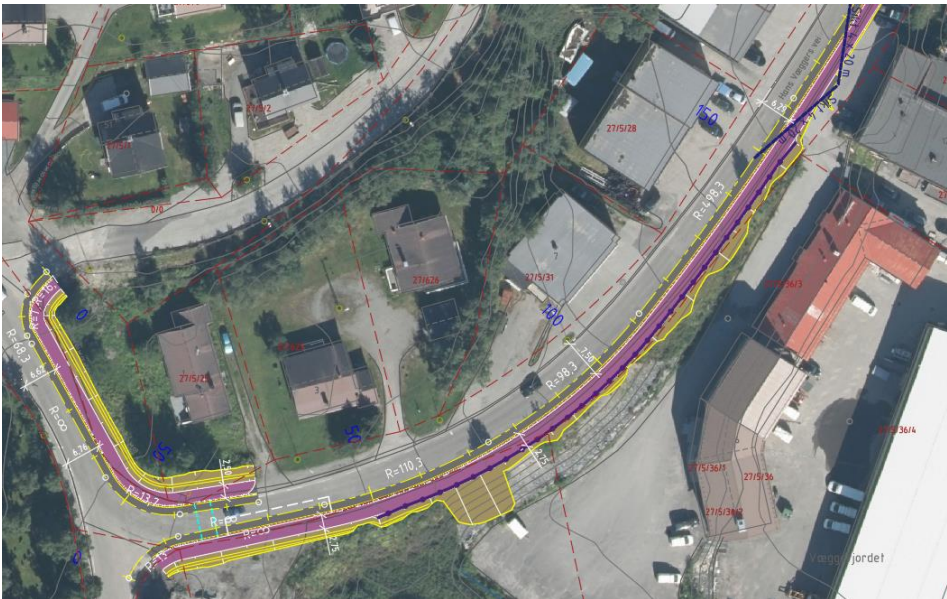
Figur 3: Fortausbredde sørøst for Hans Væggers vei foreslås utvidet til 2,75 m på strekningen ned til avkjørselen ved Hans Væggers vei 12, for å unngå krav til kjøresterkt rekkverk.
