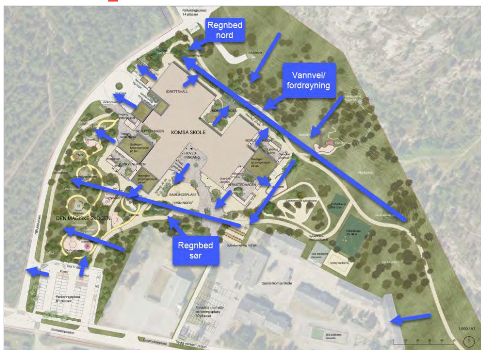
Figur 3-10 Tenkte avrenningsmønstre mellom delfelt til overvannstiltak.
