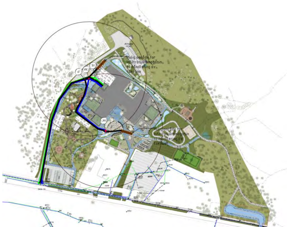
Figur 2-2 – Løsningsforslag for spillvann, forbruksvann og slokkevann i fremtidig situasjon. Grønne linjer viser spillvanssledninger, blå linjer viser vannledninger, svart sirkel viser rekkevidde på brannkum (100m) og rød linje viser planavgrænsning.
