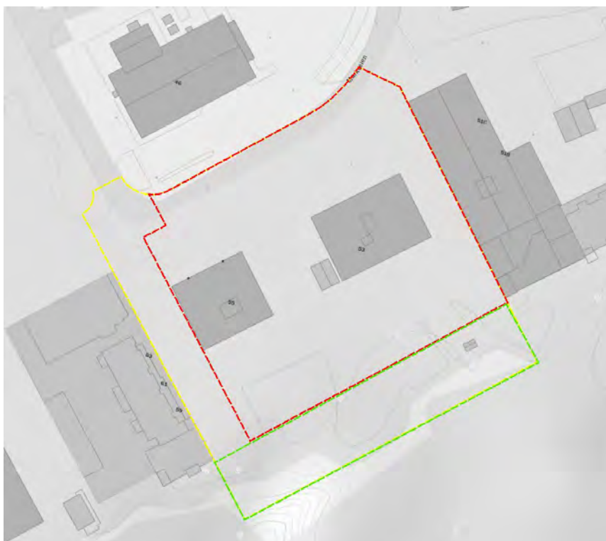
Figur 7-1. Oversikt over overvannsområder i planområdet. Det røde feltet ligger innenfor tomtegrense for tiltaket og inngår i beregningene under. Overvann for trafikkarer langs Markveien, må sees på i detaljfasen.
