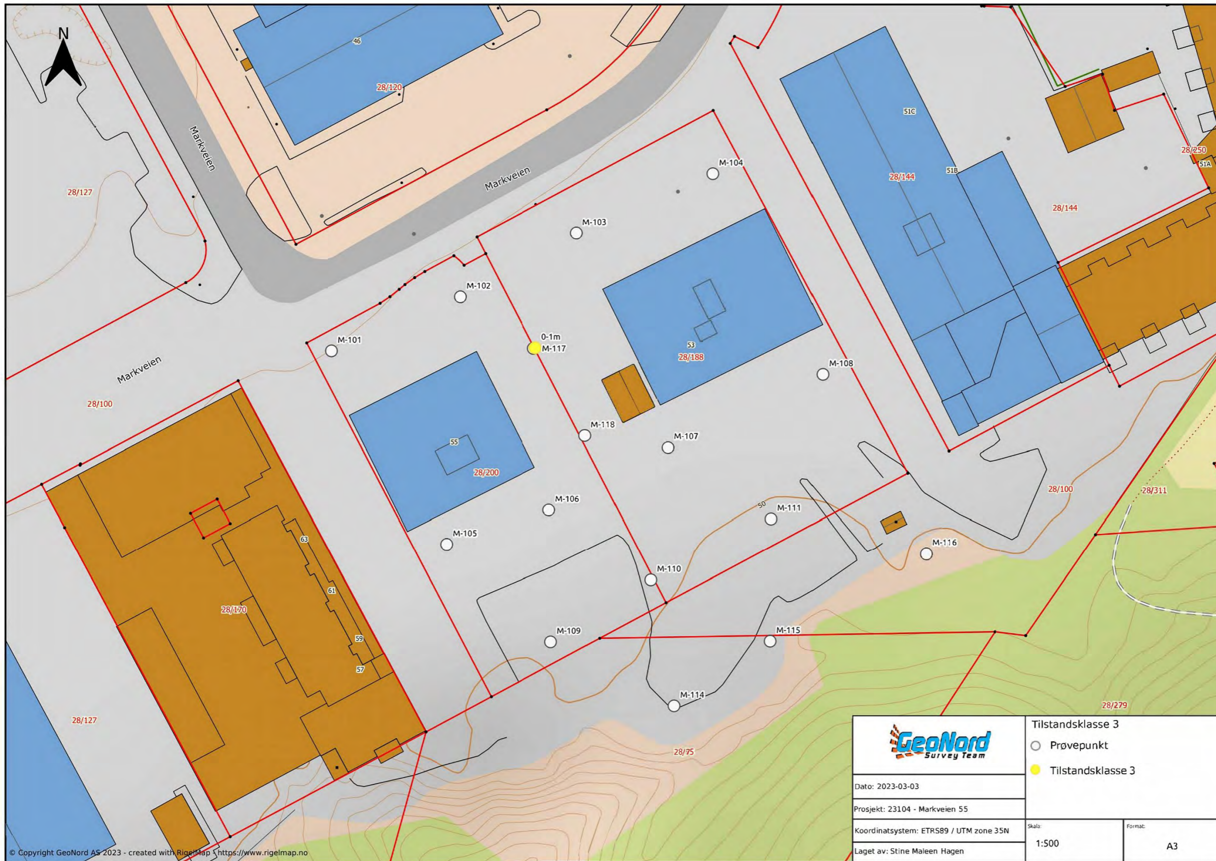
Figur 8: Oversikt over jordprøver hvor tilstandsklasse 3 er høyest påvist klasse, markert med gult punkt.
