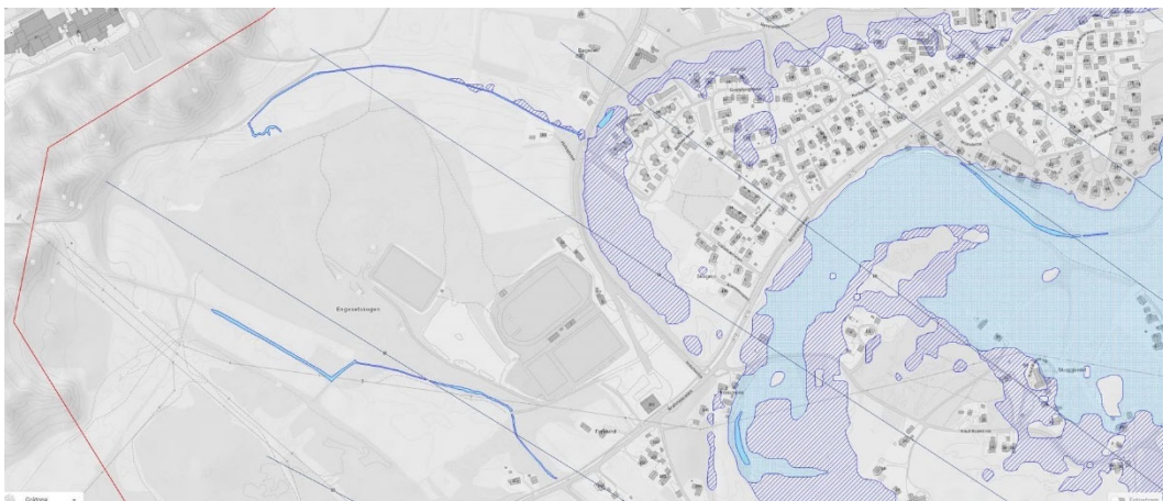
Figur 52 – Utsnitt av NVE sitt flomsonekart som viser 200-års flom. Skraverte områder er lavpunkter som må undersøkes nærmere, de blå områdene er flomutsatte.
