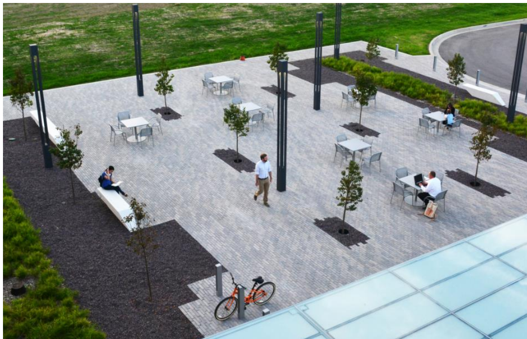
Bilde 13. Eksempel på bruken av permeabel belegningsstein på en torgplass. I tillegg bør det etterstrebe tregruberister som beskytter trær i by mot tråkk nær stammen og rotsystemet, samt sikrer vanntilførsel. Det bør anlegges vannspeil/-dam i midten av torget som et tørt magasin som fylles opp med vann ved ekstrem nedbør, jf. tiltak 1 og 7. Kilde: Berkebile Nelson Immenschuh McDowell, Inc. (BNIM).
